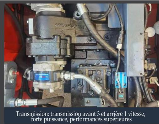
Transmission: transmission avant 3 et arrière 1 vitesse, forte puissance, performances supérieures
