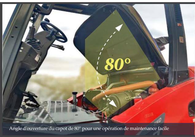
Angle d'ouverture du capot de 80° pour une opération de maintenance facile
