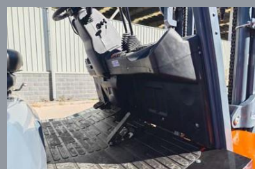
Inclinez le cylindre vers le bas pour améliorer l'espace pour les jambes
