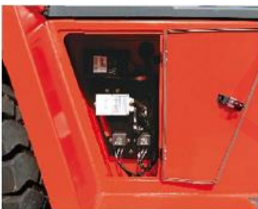
Armoire électrique intégrée indépendante
