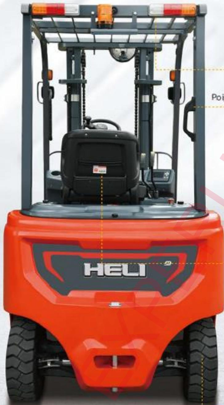
L'ensemble du camion est équipé en standard d'un système d'éclairage à LED, d'une grande luminosité, d'une longue durée de vie et d'une plus grande économie d'énergie.
