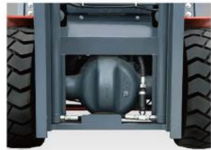
Essieu moteur : tambour de frein intégral, carter d'essieu moulé intégral, conception de joint d'huile de demi-arbre, engrenage de haute précision avec grande coïncidence
