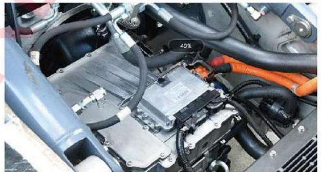
Le système d'alimentation intégré réduit le faisceau de câbles, ce qui réduit considérablement la perte de transmission de l'énergie électrique. Et les niveaux de pièces et de modules de contrôle sont clairs et pratiques pour la maintenance ;
