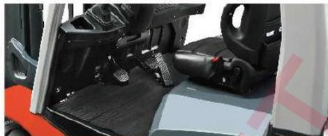
Lorsque le cylindre d'inclinaison s'enforce dans la disposition, l'espace supérieur de la plaque de fond augmente et l'espace des jambes est agrandi ;
