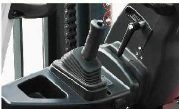
La poignée de commande du frein de stationnement à cliquet permet d'économiser de la main d'œuvre ;
