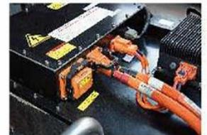
**Protection de la sécurité de la tension au niveau du système :** Le chariot élévateur se caractérise par la conception intégrée/la plus courte de la connexion de tension et la multiple protection de surveillance d'isolation ;
