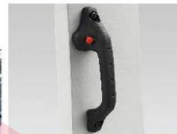
L'accoudoir est équipé d'un interrupteur de Maxon pour la marche arrière, ce qui rend la conduite plus sûre ;
