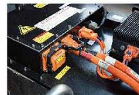
Protection de la sécurité de la tension au niveau du système : Le chariot élévateur se caractérise par la conception intégrée la plus courte de la connexion de tension et la multiple protection de surveillance d'isolation ; Conception sectionnelle de sécurité de la tension au niveau du système : lorsque l'interrupteur de maintenance est retiré et que le système tombe en panne ou que la clé est déconnectée, le système de tension est automatiquement déconnecté et la tension maximale ne doit pas être supérieure à 76,8 V.
