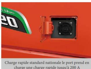
Charge rapide standard nationale le port prend en charge une charge rapide jusqu'à 200 A
