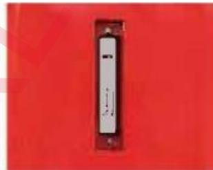
Niveau et qualité de l'huile hydraulique facile à vérifier (indicateur de niveau)
