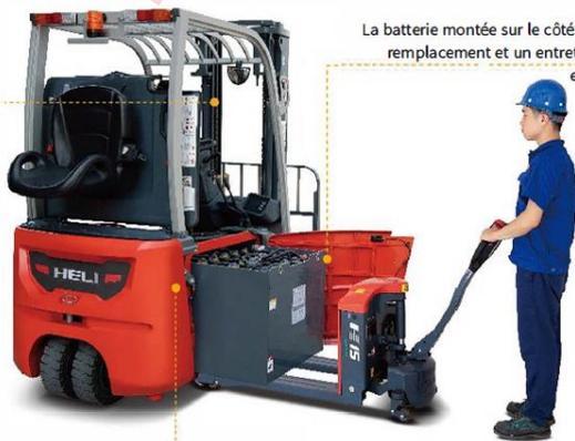
La batterie montée sur le côté offre un remplacement et un entretien plus efficaces.
