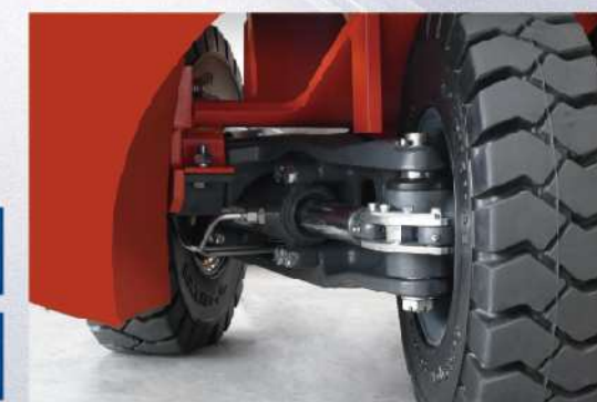
Pont de direction moulé
