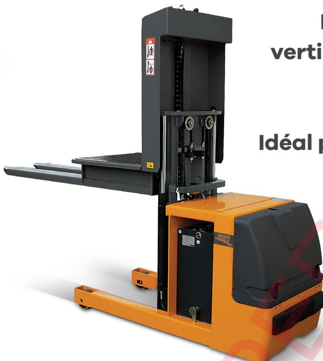
**Le préparateur de commande vertical avec opérateur embarqué et plateau relevable, fiable et robuste. Idéal pour les opérations de picking manuel.**
