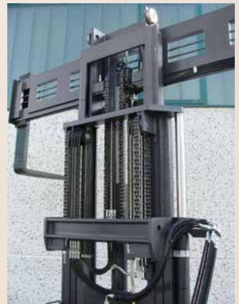
**Mât de levage**, réalisé en acier extrait au manganèse, pour garantir un important degré de rigidité, de fortes portées résiduelles aussi avec des centres de gravité éclairés et des coefficients de sécurité élevés.
