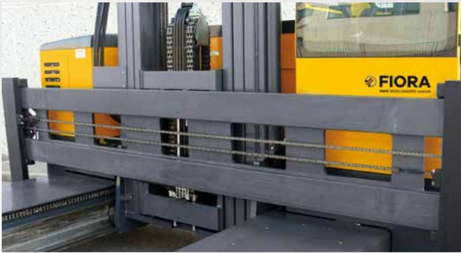
**Tablier porte-fourches large et écartement hydraulique des fourches** qui permettent de transporter des matériaux longs, en stabilisant la charge.
