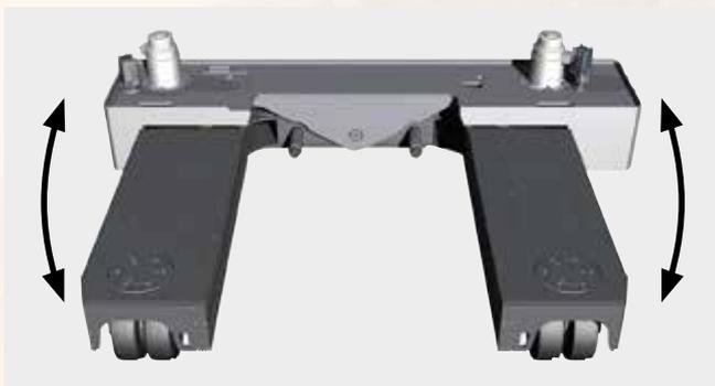
**Châssis oscillant équilibré** divisé en deux parties (compensation mécanique) pour travailler également sur des sols en léger dénivelé et en conservant le contact permanent des roues au sol, améliorant ainsi la stabilité de la machine.
