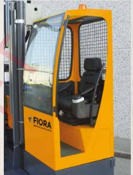
**Cabine de conduite frontale,** ergonomique avec siège sur ressorts et réglable, recouvert d'un revêtement robuste et antiallergique. Les poignées de soutien rendent l'accès à la cabine encore plus aisé et en toute sécurité.
