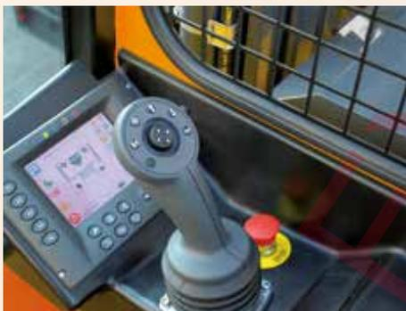
**Joystick proportionnel multifonction** câblé en Can-Bus pour un contrôle des mouvements de la machine sensible et précis. **Grand écran couleurs à cristaux liquides**, incliné vers l'opérateur avec touches de fonctions bien visibles.
