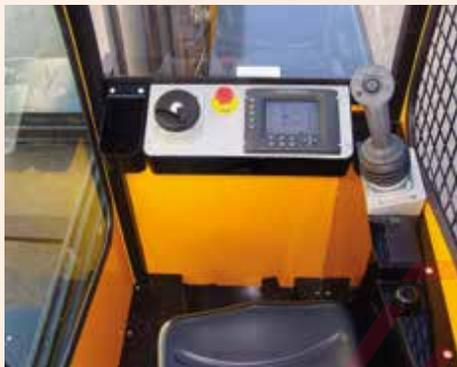
**Joystick proportionnel multifonction** câblé en Can-Bus pour un contrôle des mouvements de la machine sensible et précis. **Grand écran couleurs à cristaux liquides**, incliné vers l'opérateur avec touches de fonctions bien visibles.
