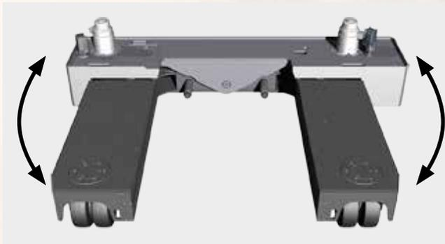
**Châssis oscillant équilibré** divisé en deux parties (compensation mécanique) pour travailler également sur des sols en léger dénivelé et en maintenant le contact permanent des roues au sol, améliorant ainsi la stabilité de la machine.
