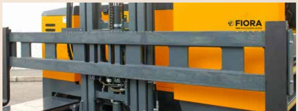
**Tablier porte-fourches large et écartement hydraulique des fourches** qui permettent de transporter des matériaux longs, en stabilisant la charge.
