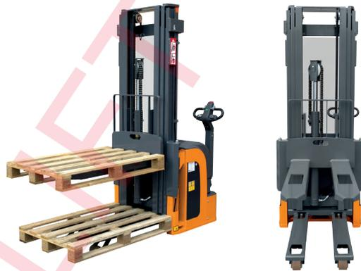
La maintenance est facilitée par une grande ouverture dans le châssis qui permet de remplacer la roue de traction sans avoir besoin de soulever tout le chariot. Les nouvelles couvertures en polyéthylène avec système d'ouverture facilitée permettent un accès maximal à tous les composants dans les opérations de maintenance ordinaire et extraordinaire.
