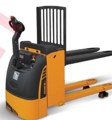
Les transpalettes élévateurs 316 KN-C et 316 KN-M permettent d'associer dans un seul chariot la fonction traditionnelle de transpalette et la possibilité de stocker la charge à différents niveaux de hauteur. Idéals pour les opérations de picking manuel et de stockage effectuées dans des espaces et sur des parcours étroits en toute sécurité et avec confort, même pour la manutention de charges superposées.
